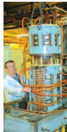
Vue de la cuve cylindrique de l'installation RASPLAV lors de sa préparation pour le Programme expérimental MASCA.
