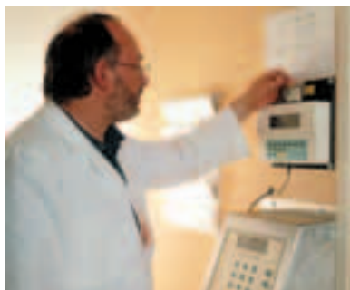
Les dosimètres électroniques sont un outil de gestion des doses de radiation employés à Saclay, en France.
